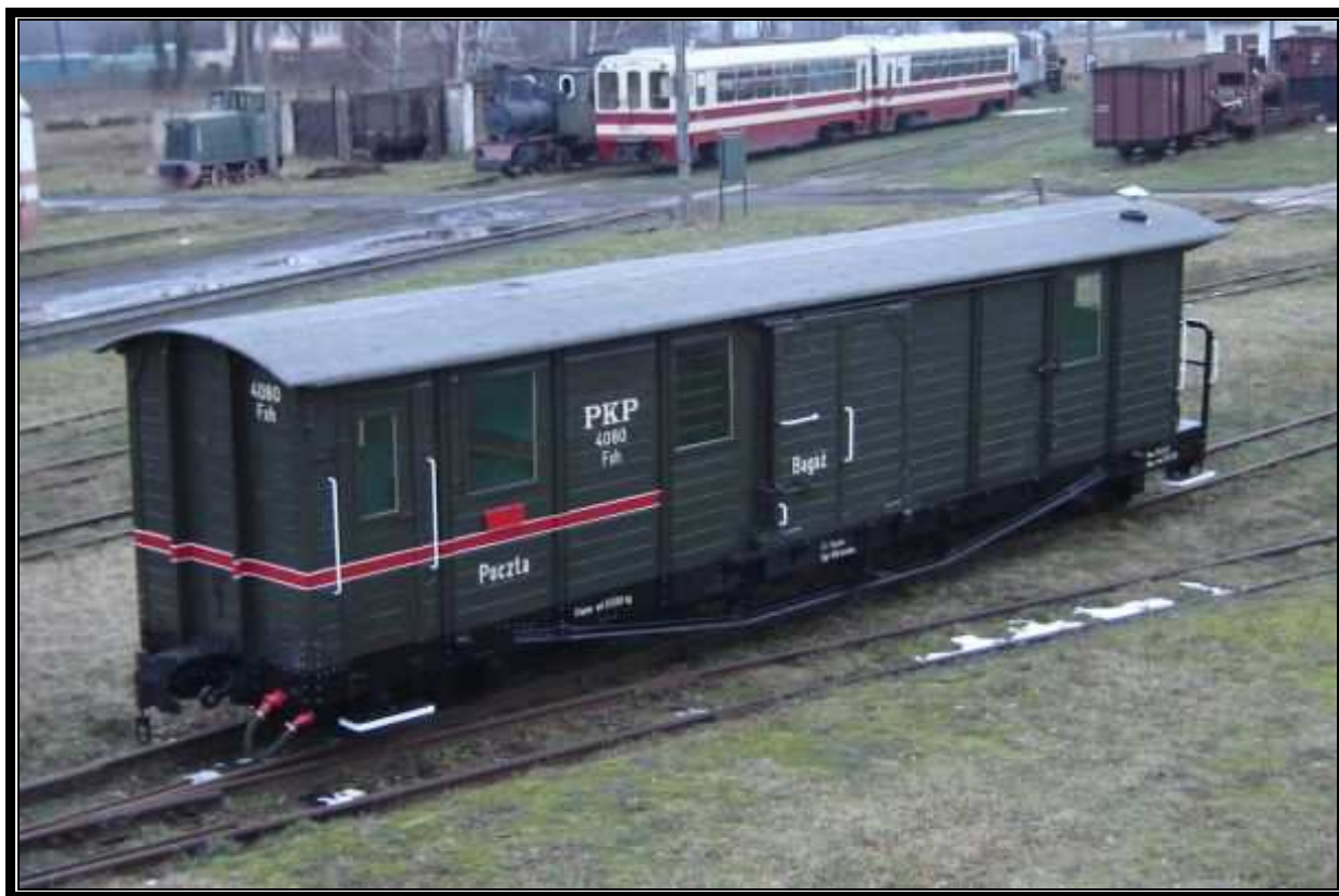
Wagon pocztowo-bagażowy Rogowskiej Kolei Wąskotorowej Fxh 4080, zbudowany na bazie przedwojennego wagonu towarowego produkcji Zakładów Ostrowieckich, z 1928 r. Ponad napisem „Poczt” widoczna osłonięta klapką szczelina do wrzucania listów (fot. Wikipedia)
